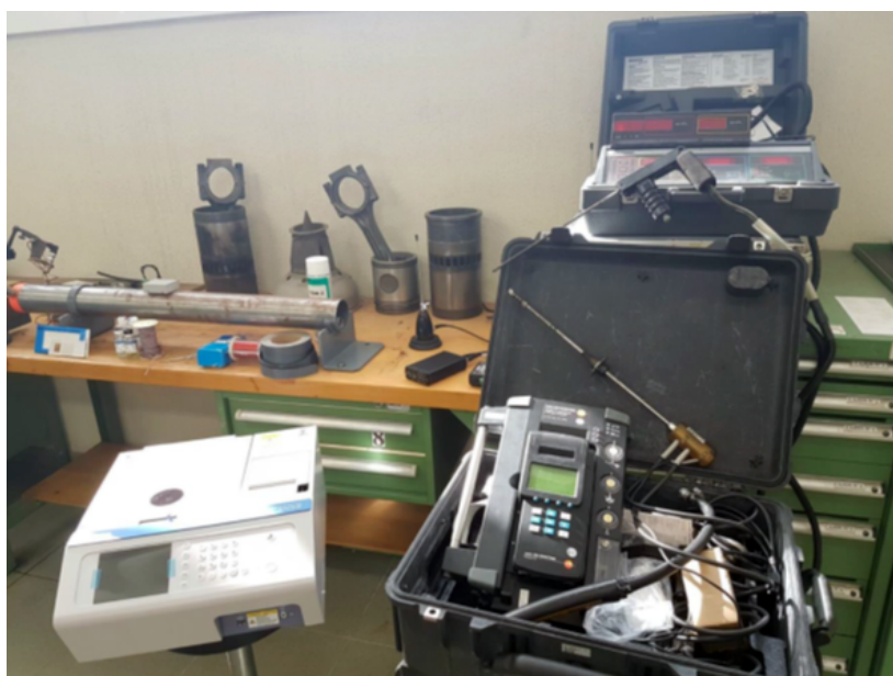
Figura 3. Equipo TESTO 350 Marine. Fuente. Elaboración propia
